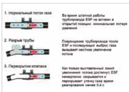
Рис. 2. Принцип действия клапана ESF
