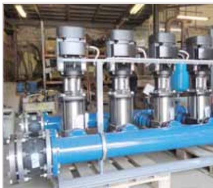
Модульная насосная станция «ГидроСи» на производственной базе «СИНТО»
