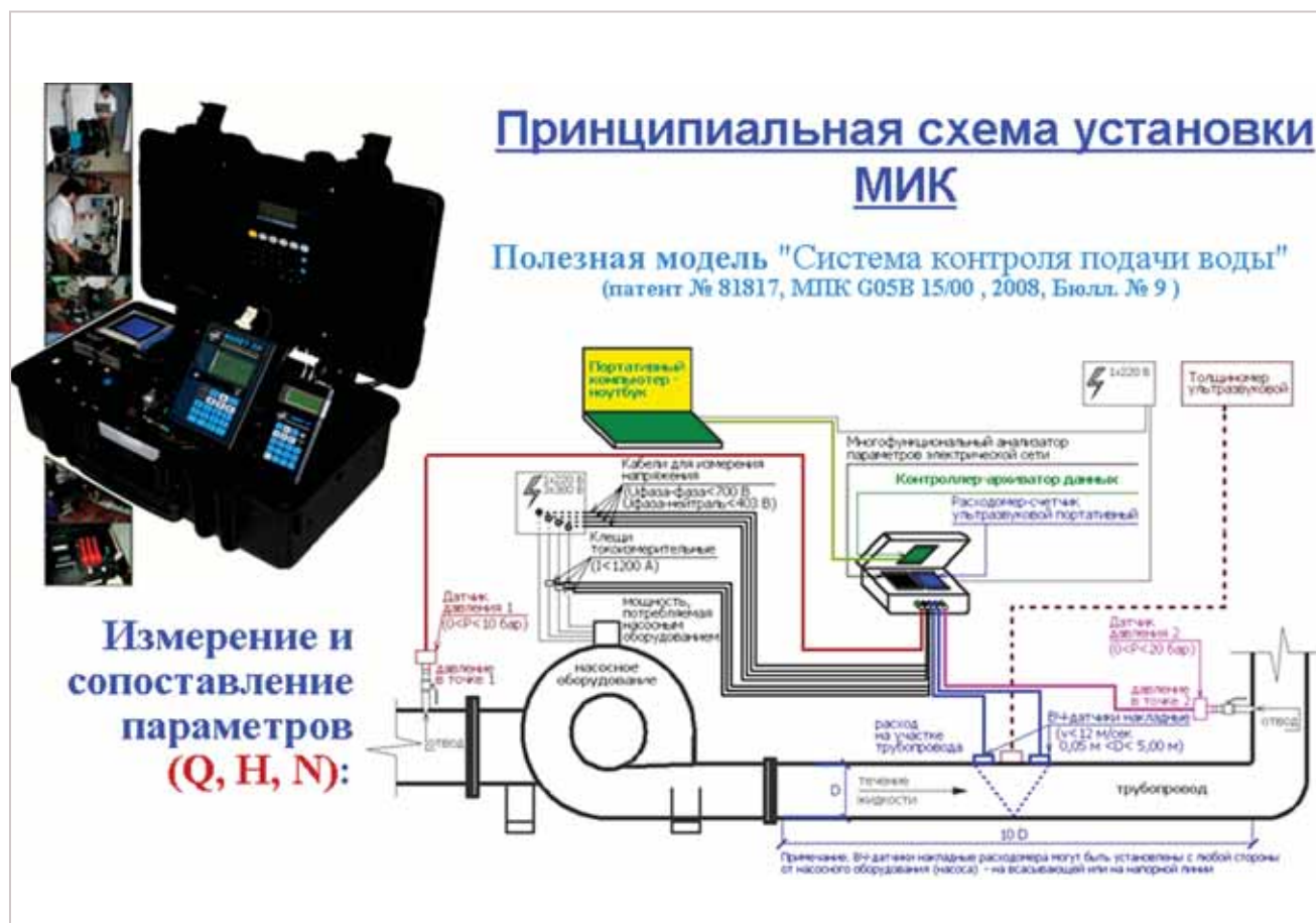
Рис. 5. МИК. Внешний вид и схема установки компонентов для замеров
