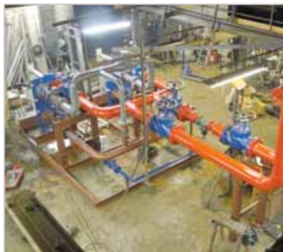
Автоматизированный модульный тепловой пункт «СиТерМ» на производственной базе «СИНТО»
