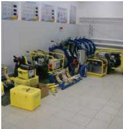
Фото 1. Учебный класс. Оборудование для сварки полимерных труб деталями с закладными нагревателями и встык нагретым инструментом
