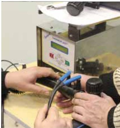
Фото 2. Учебный класс. Оборудование для сварки полимерных труб деталями с закладными нагревателями
