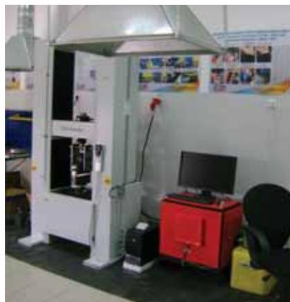
Фото 4. Испытательная лаборатория. Разрывная машина производства фирмы SHIMADZU (Япония)
