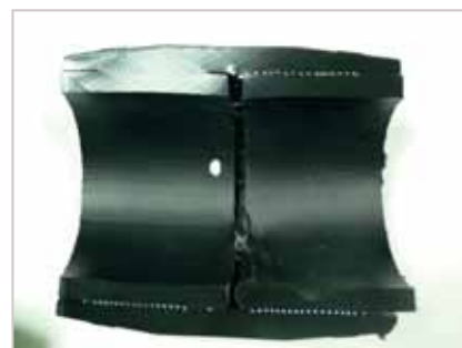
Рис. 5. Нарушение при сборке соединения. Стык свариваемых труб Ø 63 мм попал в горячую зону муфты
