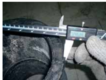
Рис. 7. «Просаженная» труба \varnothing 250 мм. Реальный ее диаметр гораздо меньше номинального. Согласно ГОСТ Р 50838-2009 предельное отклонение величины диаметра в этом случае +1,5 мм. Для наглядности при измерении диаметра использован штангенциркуль
