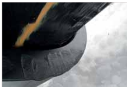
Рис. 2. Тот же объект, что и на рис. 1. Недопустимые забоины на трубе и муфте с ЗН Ø 400 мм в результате применения стальной кувалды для посадки муфты
