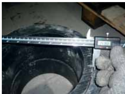
Рис. 7. «Просаженная» труба \varnothing 250 мм. Реальный ее диаметр гораздо меньше номинального. Согласно ГОСТ Р 50838-2009 предельное отклонение величины диаметра в этом случае +1,5 мм. Для наглядности при измерении диаметра использован штангенциркуль
