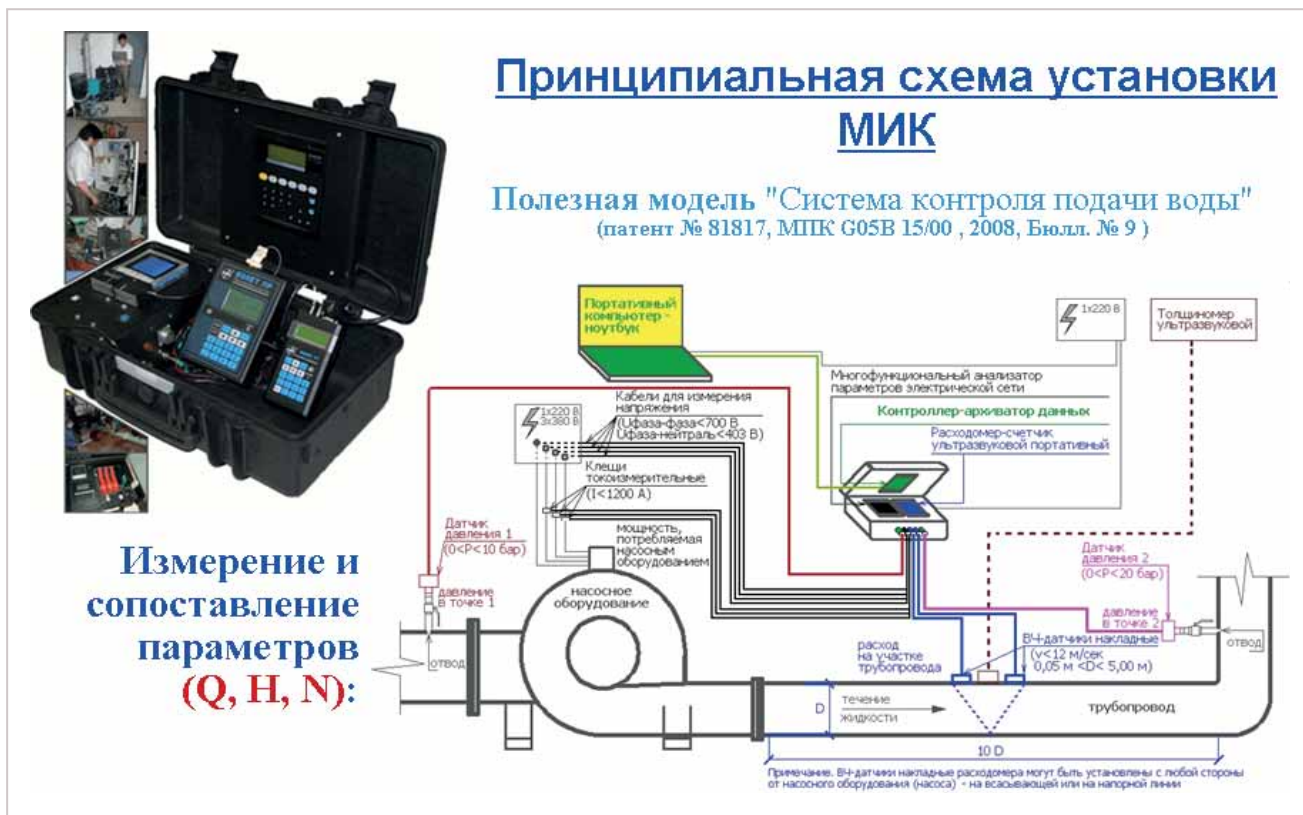
Рис. 1. МИК. Внешний вид и схема установки компонентов для замеров
