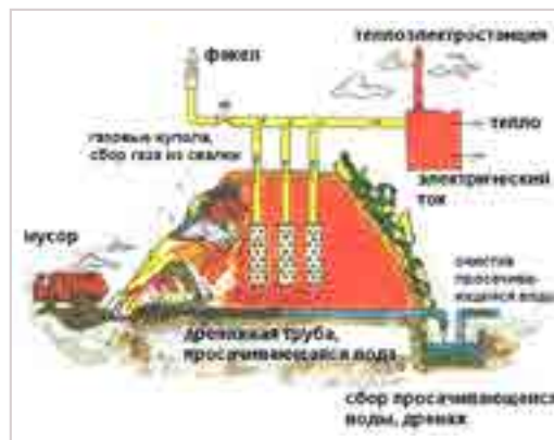
Схема получения газа из твердых бытовых отходов
