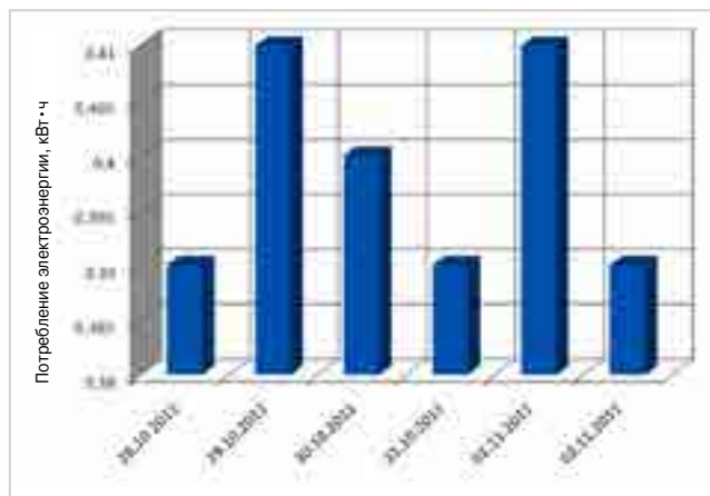
Рис. 3. Суточное потребление электроэнергии для обследованной СКЗ, работающей в режиме автоматического поддержания защитного тока
