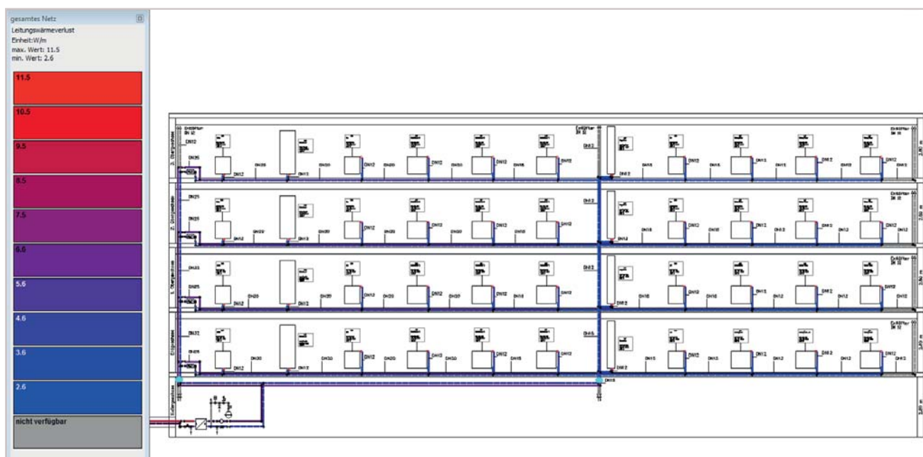
Рис. 3. Визуализация теплотерь трубопроводов с помощью liNear Data-Coloring
