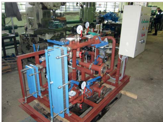
БИТП KV Thermo.TS.2.RMH760B
