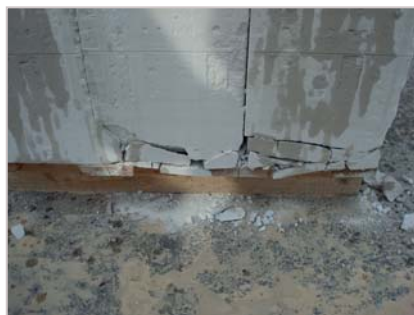
Рис. 5. Повреждение нижних рядов изделий при нарушении условий транспортировки
