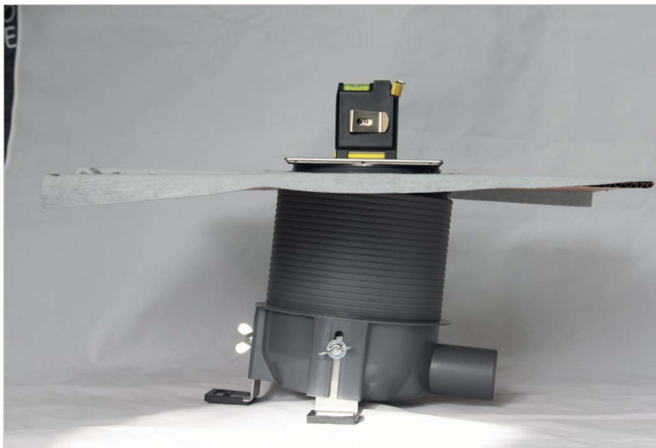
Пример монтажа трапа HL540 (корпус стоит под уклоном к отводящей трубе, при этом надставной элемент с решеткой стоит ровно, показано уровнем)
