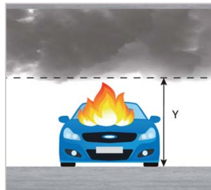
Рис. 2. Резервуар дыма при поперечной системе дымоудаления
