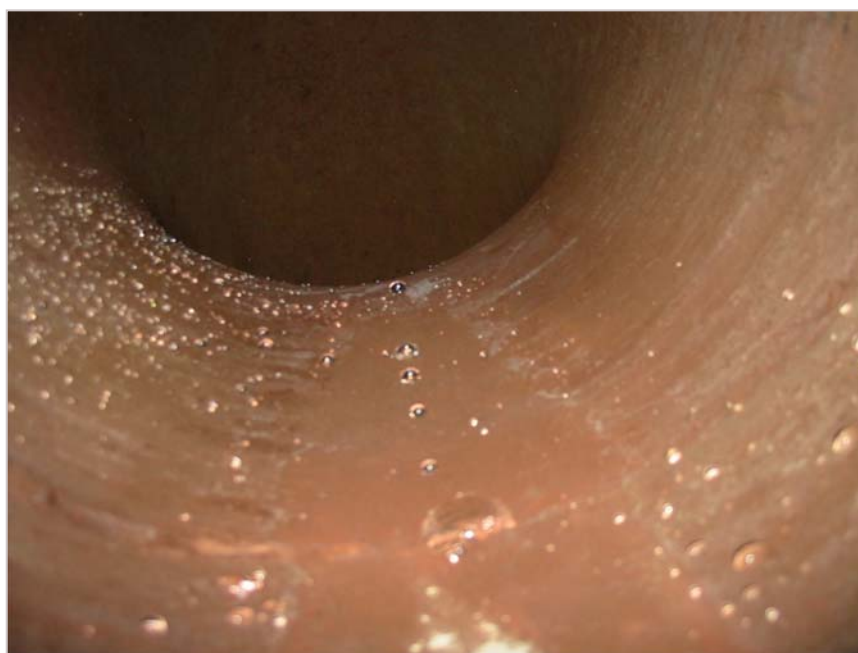
Рис. 3. Модифицированная поверхность трубы по МАК-технологии
