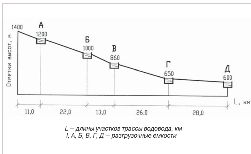
Рис. 1. Высотная схема водовода
