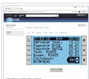
Отображение экрана полевого контроллера в различных браузерах
