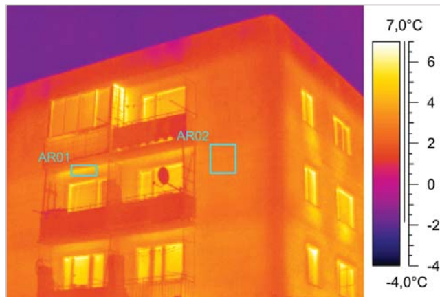
Рис. 3. Термограмма фрагмента торцевого фасада здания
