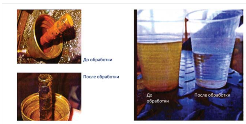
Рис. 21. Состояние оборудования и воды до и после ЭМВ
