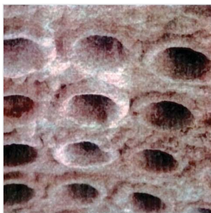
Без химводоподготовки Через 8 месяцев после ЭМВ Рис. 7. Результаты применения ЭМВ на паровом котле
