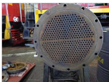
Рис. 15. Общий вид маслоохладителя после обработки, гидравлической промывки и механической очистки
