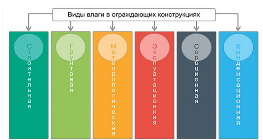
Рис. 1. Влага в ограждающих конструкциях
