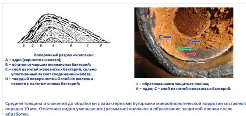
Рис. 12. Размытие «колпаков» микробиологической коррозии в результате применения ЭМВ
