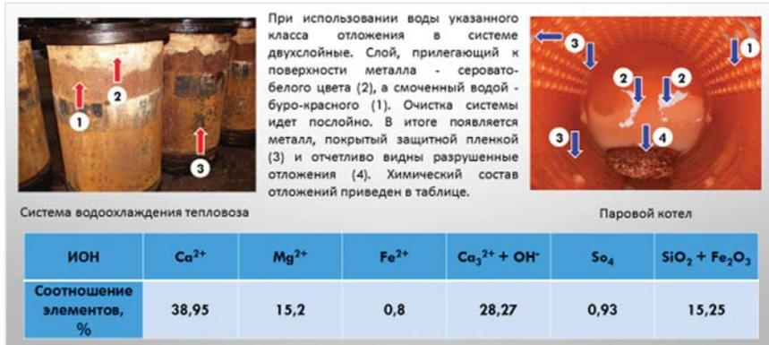
Рис. 12. Особенности очистки от отложений системы водоохлаждения тепловоза (парового котла) при использовании воды кальций-гидрокарбонатного класса
