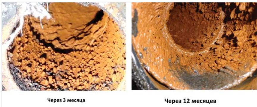
Рис. 18. Сравнительное состояние трубы подачи воды от дизеля к радиаторам через три и двенадцать месяцев после обработки
