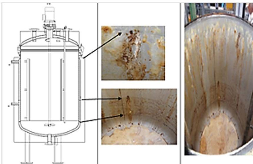
Рис. 11. Коррозионные разрушения системы водоохлаждения импортного оборудования (Германия), выполненного из нержавеющей стали, из-за употребления воды низкого качества (псевдоустойчивой)
