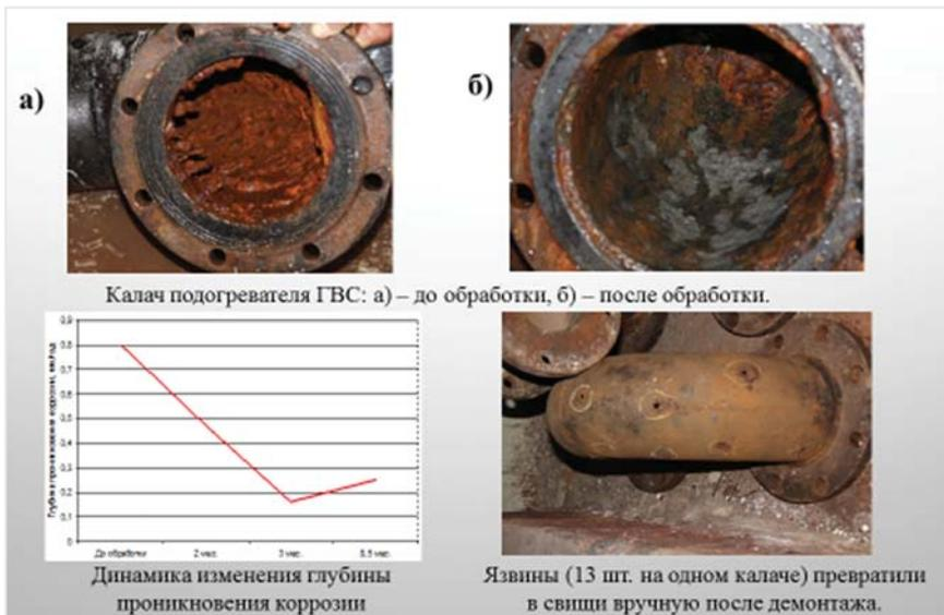
Рис. 6. Возможность использования энергетического метода для обработки изношенных тепловых сетей
