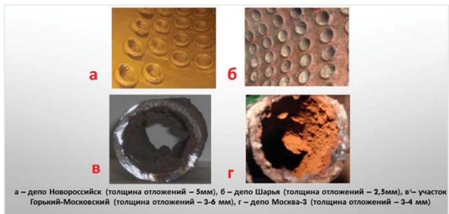
Рис. 5. Состояние внутренних поверхностей барабанов котлов и трубопроводов до ЭМВ
