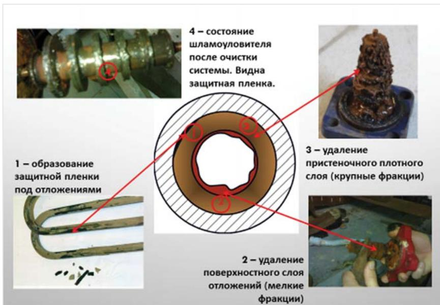
Рис. 8. Этапность технологического процесса обработки системы с толщиной отложений более 3 мм энергетическим методом
