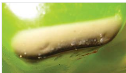
Рис. 2. Биообрастание трубопроводов из металлопласта (покрытие полипропилен) при использовании низкозамерзающей жидкости
