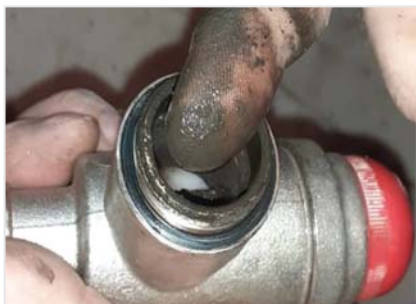
Рис. 6. Вид седимента в разобранном воздухоохладителе из системы теплого пола
