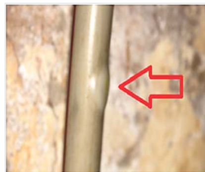
Рис. 1. Образование «отдулин» (указано стрелкой) на поверхности трубопроводов после двух лет эксплуатации. В этом месте произойдет разрушение конструкции
