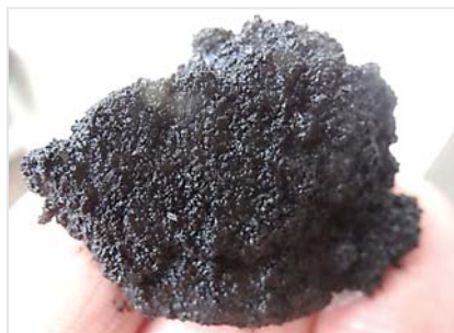
Рис. 7. Вид отложений на сетке фильтра системы теплого пола
