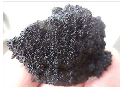
Рис. 3. Вид образовавшегося в результате микробиологической коррозии и ЭМВ скоагулировавшегося магнетита в металлопласте и низкозамерзающем теплоносителе
