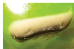
Рис. 10. Биообрастание металлопластовых трубопроводов в системе теплого пола
