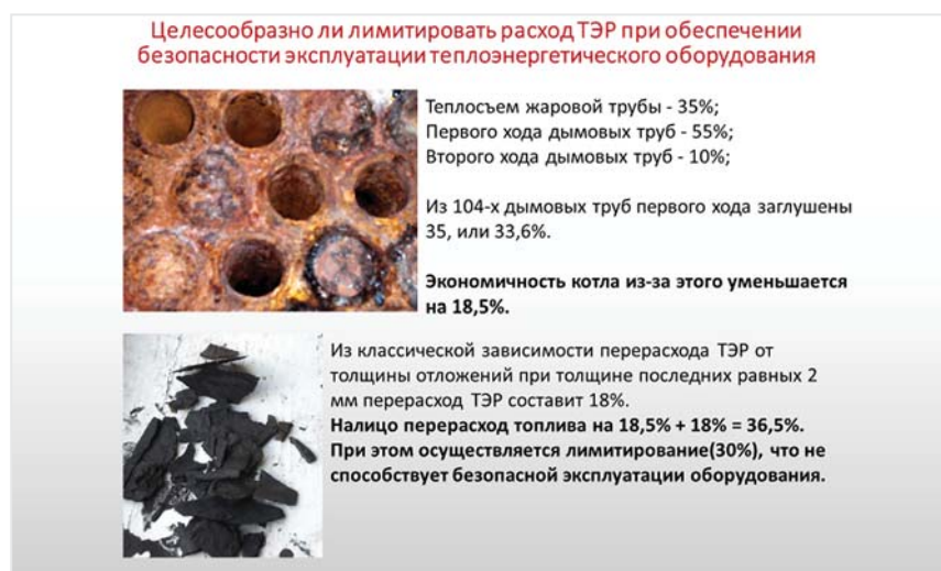
Рис. 3. Влияние несоблюдения параметров ВХР на энергоэффективность работы теплоэнергетических систем
