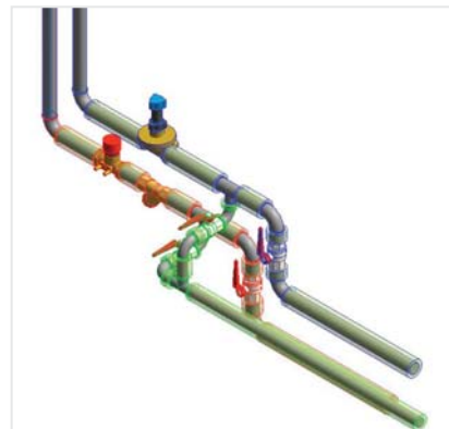
Узел подключения стояка двухтрубной системы отопления
