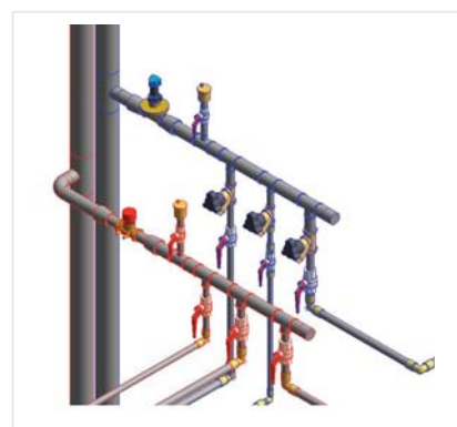
Узел подключения поэтажного коллектора системы отопления
