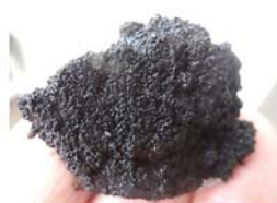
Рис. 11. Вид продуктов жизнедеятельности продуцирующих в трубопроводе железовосстанавливающих бактерий
