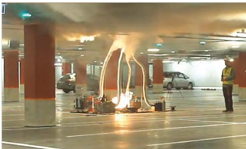
Рис. 1. Дымовой слой в подпотолочном пространстве
