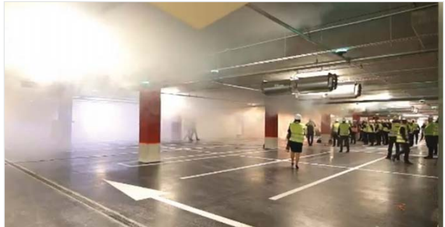
Рис. 2. Влияние работы струйных вентиляторов на распространение искусственного дыма в продольном направлении
