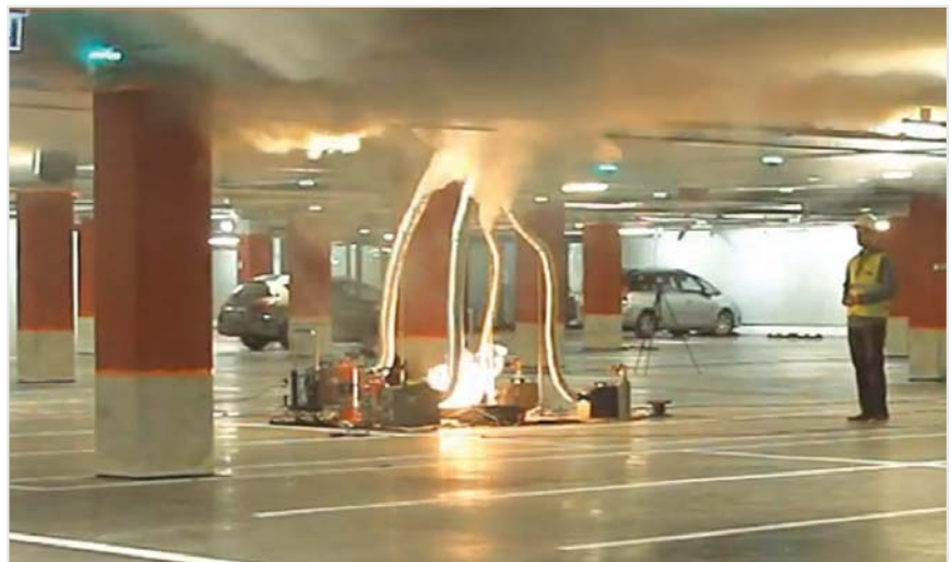
Рис. 1. Дымовой слой в подпотолочном пространстве
