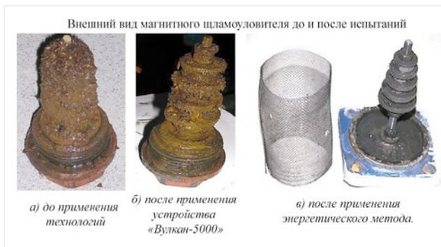
Рис. 20. Сравнительные испытания современного импортного устройства «Вулкан 500» (Германия) и ЭМВ на тепловых сетях ОАО «РЖД» (2014–2015 гг.)
