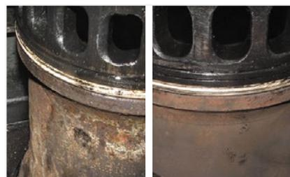
Рис. 5. Состояние штуков цилиндров тепловоза 2М62У № 0083 до и после обработки ЭМВ и года эксплуатации
