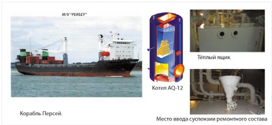
Рис. 6. Обработка водяного тракта котельной корабля «Персей» № 821439
