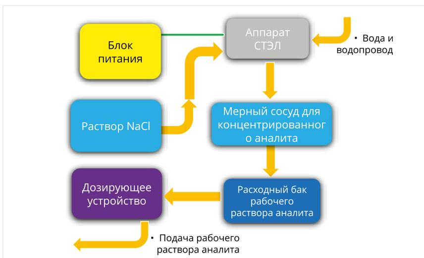
Рис. 8. Технологическая схема установки ЭХАР
