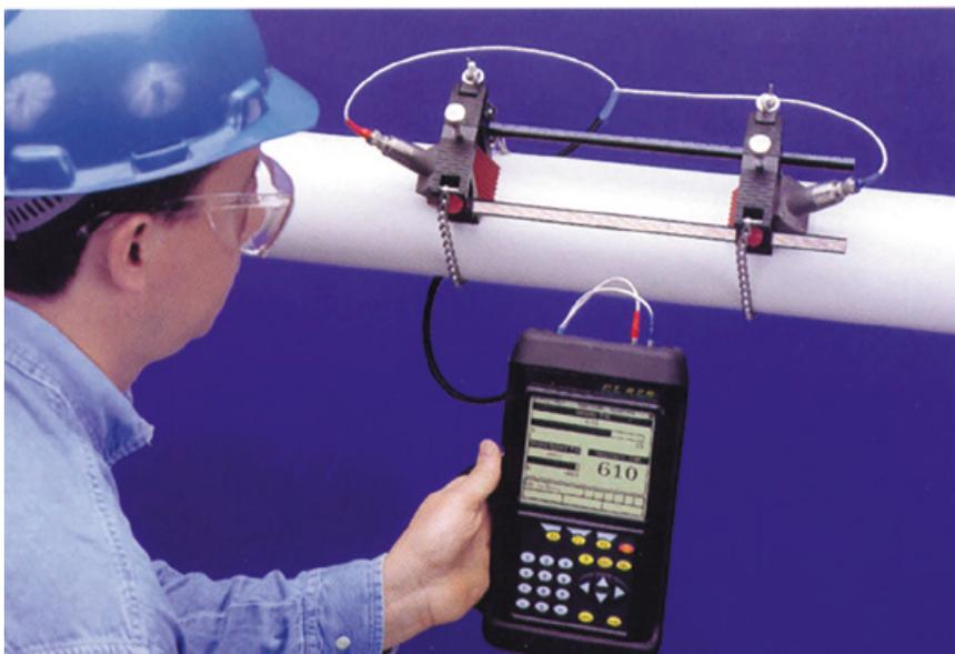
Рис. 3. Ультразвуковой расходомер в комплекте с толщиномером
