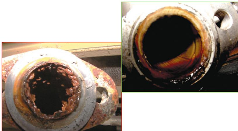
Рис. 3. Состояние водопровода вагона до и после применения ЭМВ
