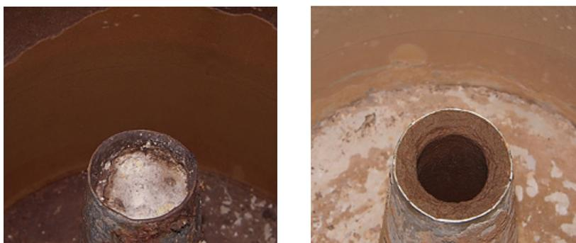
Рис. 4. Состояние патрубка титана пассажирского вагона до и через месяц после применения ЭМВ
