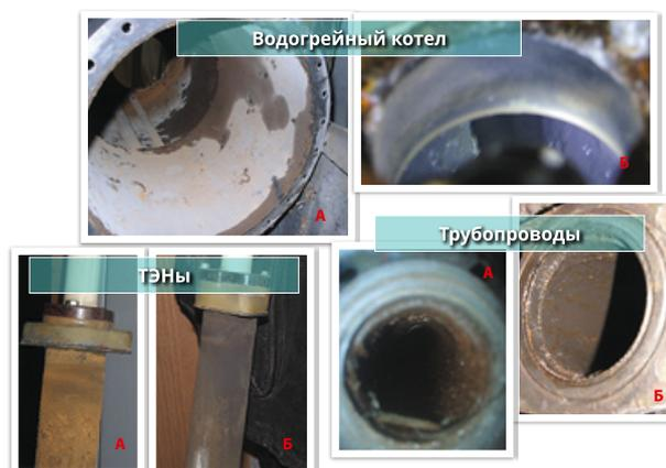
Рис. 2. Состояние систем отопления пассажирских вагонов до и после применения ЭМВ
