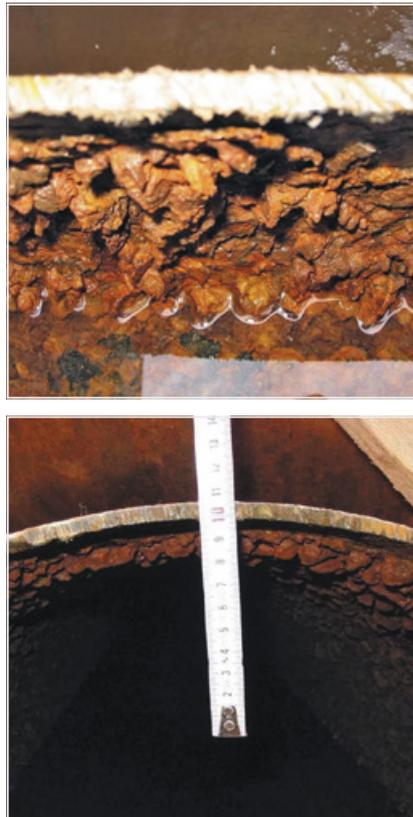
Рис. 2. Толщина слоя отложений на внутренних стенках металлических труб
