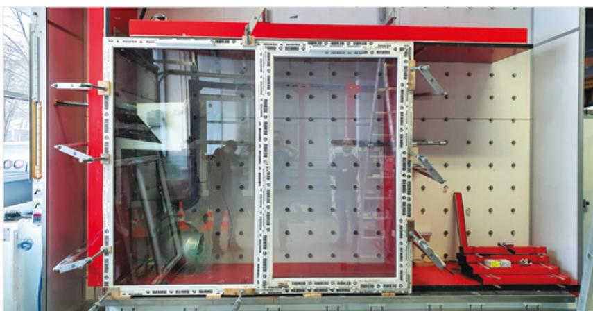
Рис. 4. Установка для испытаний на воздухопроницаемость
