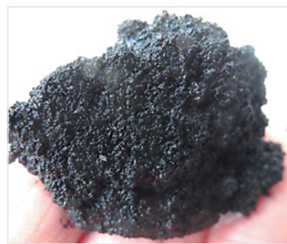
Рис. 19. Вид образовавшегося в результате микробиологической коррозии и ЭМВ скогулировавшегося магнетита в металлопласте и низкозамерзающем теплоносителе
