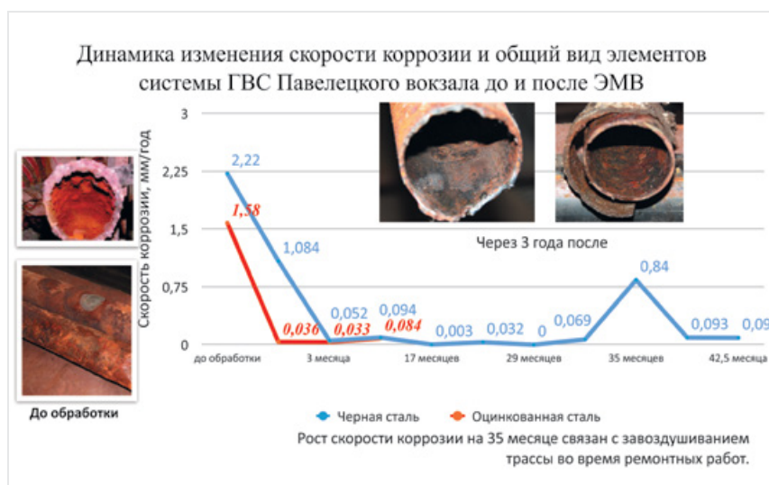
Рис. 17. Динамика изменения скорости коррозии и общий вид элементов системы ГВС Павелецкого вокзала до и после ЭМВ
