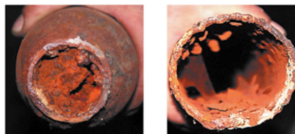
Рис. 8. Внешний вид системы ГВС пассажирского депо при невыполнении требований нормативов по интенсивности накипобразования
