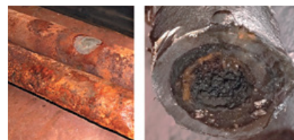
Рис. 6. Состояние сетей ГВС транспортного комплекса. Коррозионные повреждения с наружной стороны, подварки, забитое сечение коррозионно-накипными отложениями
