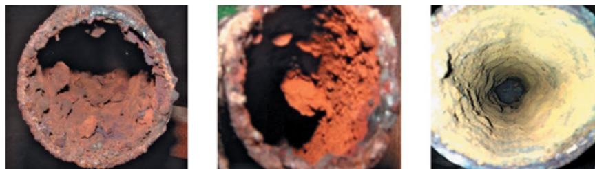
Рис. 5. Состояние сетей ГВС транспортного комплекса. Накипно-коррозионные отложения на поверхностях, контактирующих с водой, толщиной 5–6 мм
