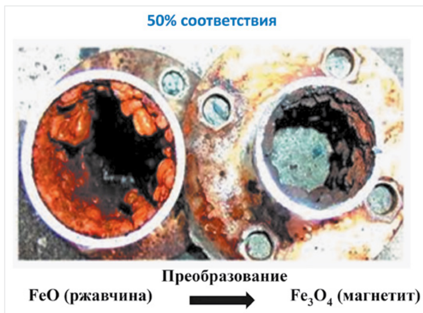
Рис. 21. Преобразования ржавчины в магнетит при использовании электронных импульсов (установка Vulkan Германия)
