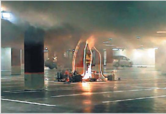
Рис. 7. Испытания противодымной вентиляции в режиме очистки от дыма
