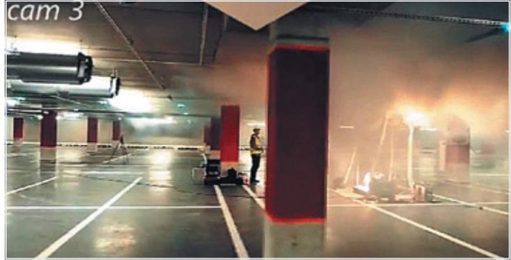
Рис. 8. Испытания противодымной вентиляции в режиме контроля распространения дыма и тепла
