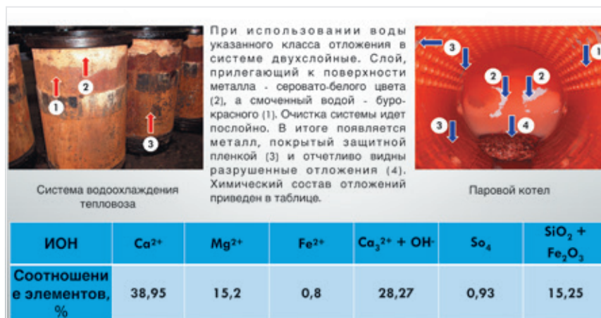
Рис. 1. Особенности очистки от отложений системы водоохлаждения тепловоза (парового котла) при использовании воды кальций-гидрокарбонатного класса
