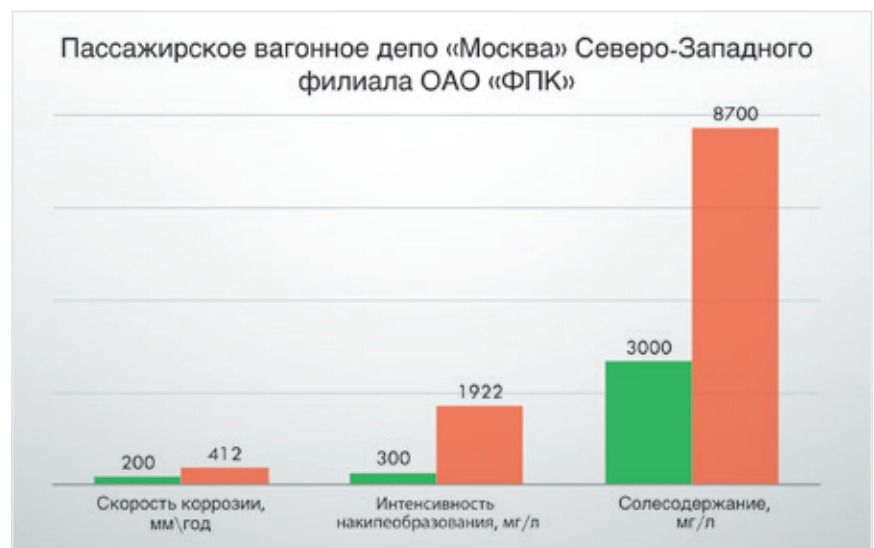
Рис. 6. Сравнимые с ПДК величины скорости коррозии, интенсивности накипеобразования, соледержания при использовании воды гидрокарбонатного класса хлоридно-магниевого с минерализацией 263 мг/л. Топливо — мазут
