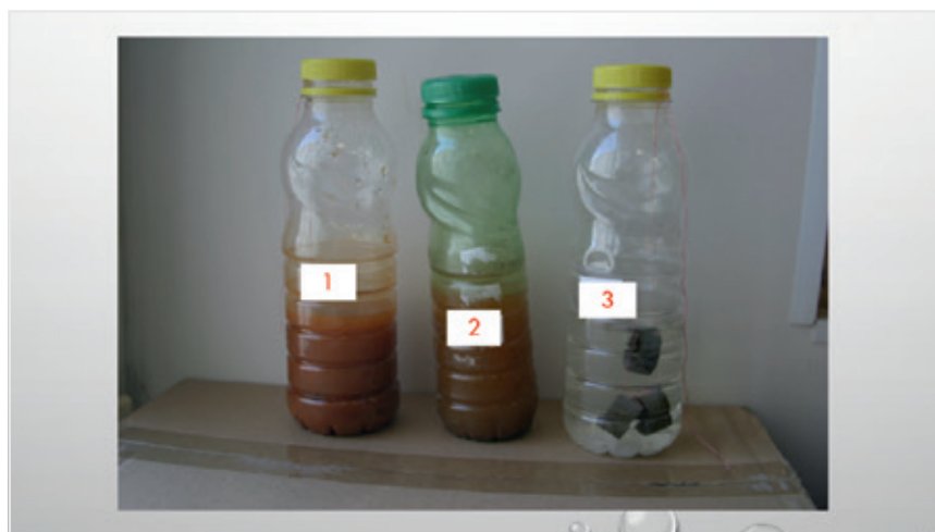
Рис. 4. Сравнительная коррозионность воды: осмотической (1), водопроводной (2), осмотической с энергентом (3)
