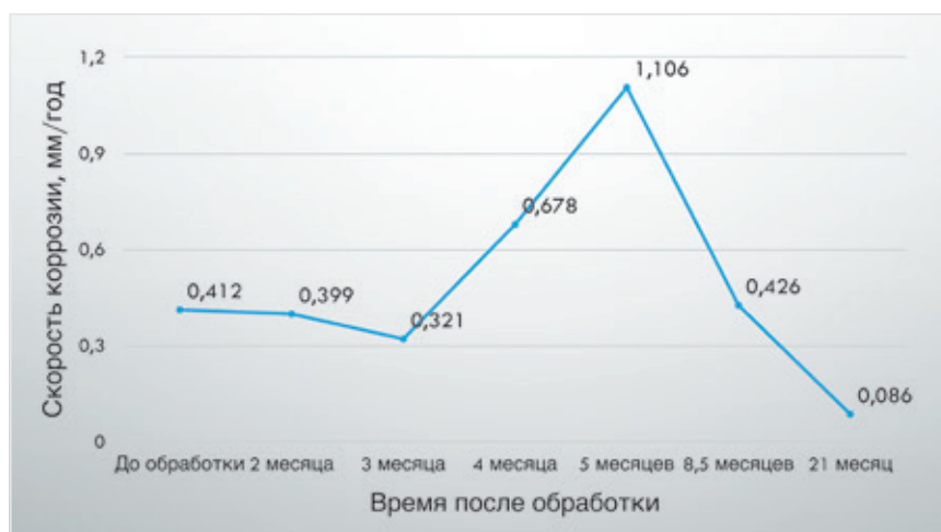
Рис. 7. Изменение скорости коррозии в системах теплоснабжения пассажирского вагонного депо Москва после обработки
