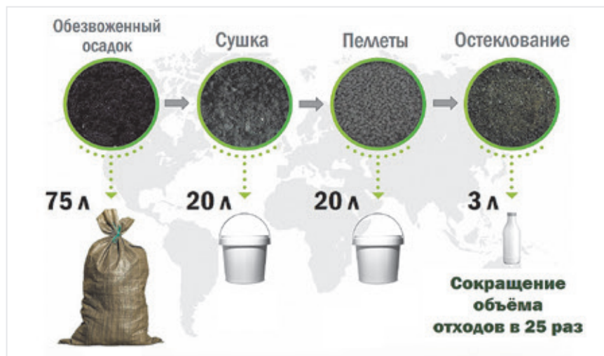
Рис. 1. Переработка илового осадка в стекло
