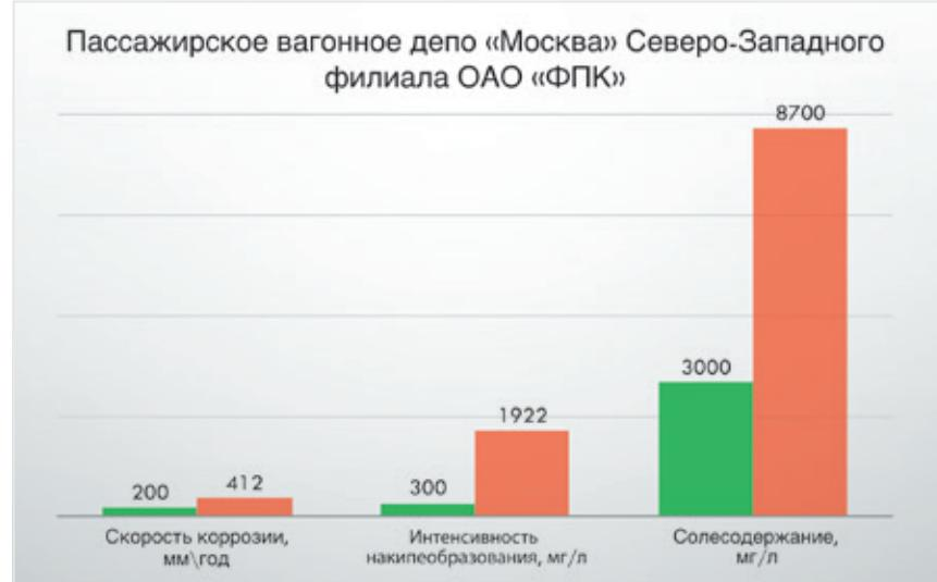
Рис. 6. Сравниваемые с ПДК величины скорости коррозии, интенсивности накипеобразования, солесодержания при использовании воды гидрокарбонатного класса хлоридно-магниевой с минерализацией 263 мг/л. Топливо — мазут
