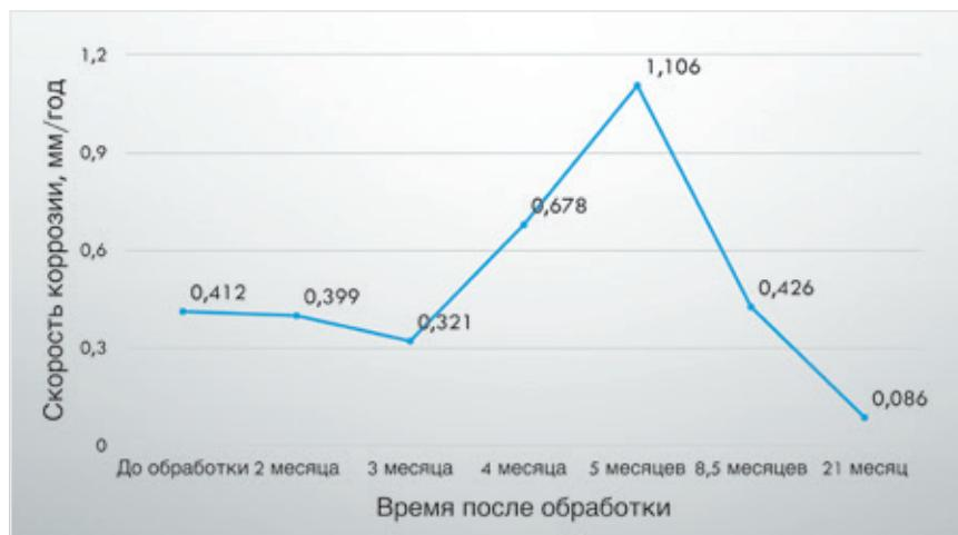
Рис. 7. Изменение скорости коррозии в системах теплоснабжения пассажирского вагонного депо Москва после обработки
