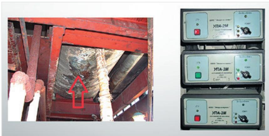
Рис. 2. Ультразвуковые приборы УПА-2М. Коррозионные повреждения деаэратора в депо при использовании ультразвукового метода
