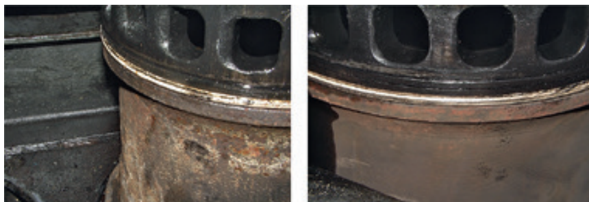
Рис. 9. Состояние втулок цилиндров до и через год после ЭМВ
