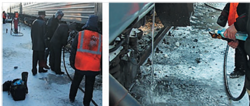
Рис. 6. Поточная обработка систем водотеплоснабжения пассажирских вагонов в эксплуатационном депо
