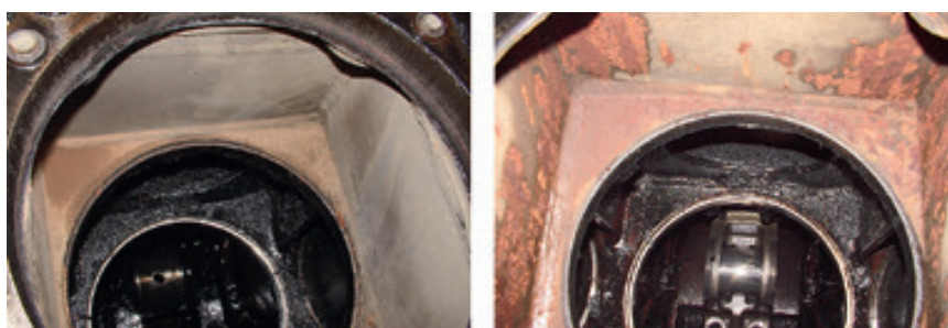
Рис. 11. Состояние рубашек охлаждения до и через год после обработки
