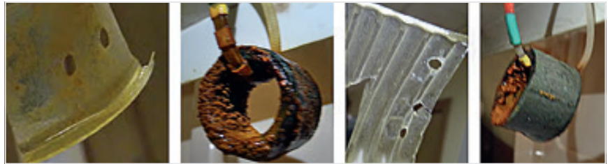
Рис. 13. Биообрастание пластика и коррозия стального образца. Экспозиция восьми месяцев. Карское море, Новая Земля, залив Благополучия (осадок внутри стального образца в воде с энергентом не закреплен на поверхности, он легко смывается)
