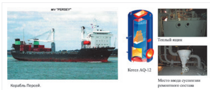
Рис. 16. Обработка ЭМВ водяного тракта котельной корабля «Персей». Обработка водяного тракта и очистка системы от накипно-коррозионных отложений проводилась в период навигации судна
