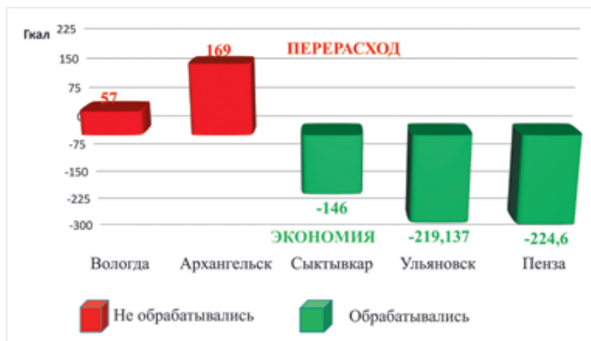
Рис. 15. Фактический перерасход / экономия теплоты на ремонтных предприятиях транспортного комплекса без и с применением ЭМВ
