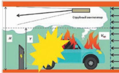
Рис. 2. Схема воздухораспределения продольной струйной вентиляцией при возникновении пожара литийионных аккумуляторов электромобиля
