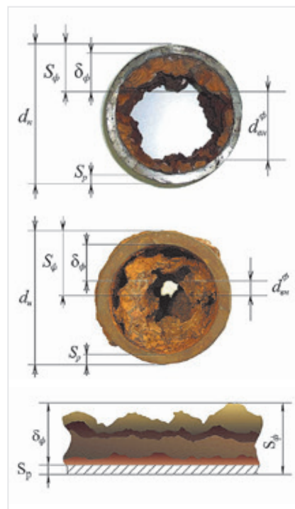
Рис. 1. Внутренние отложения в стальных — а) и чугунных трубах — б), где:
