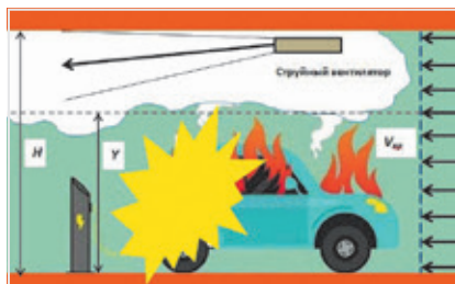
Рис. 2. Схема воздушораспределения продольной струйной вентиляцией при возникновении пожара литийионных аккумуляторов электромобиля
