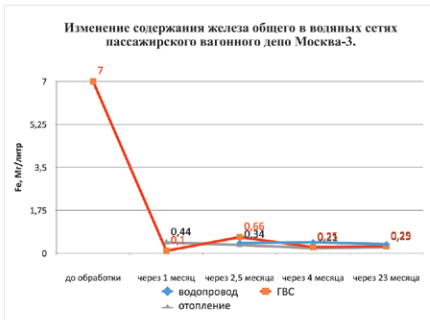
Рис. 21. Изменение содержания железа общего в тепловых сетях пассажирского вагонного депо Москва-3
