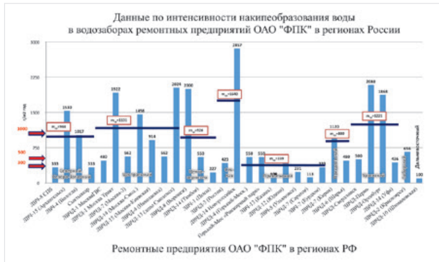
Рис. 2. Интенсивность накипеобразования воды, используемой в системах водотеплоснабжения ремонтных предприятий и подвижного состава в различных регионах РФ
