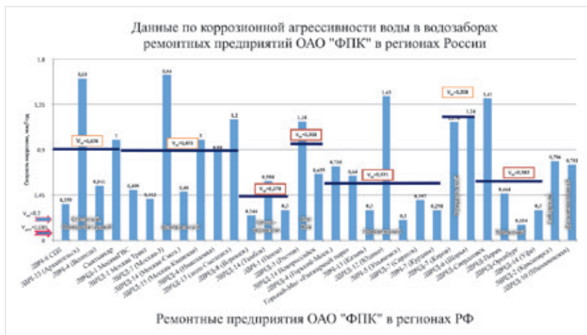
Рис. 1. Коррозионная агрессивность воды, используемой в системах водотеплоснабжения ремонтных предприятий и подвижного состава в различных регионах РФ
