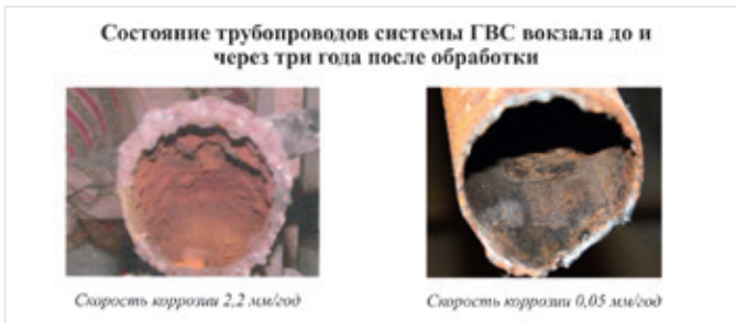
Рис. 18. Состояние трубопроводов системы ГВС Рижского вокзала до и через три года после обработки
