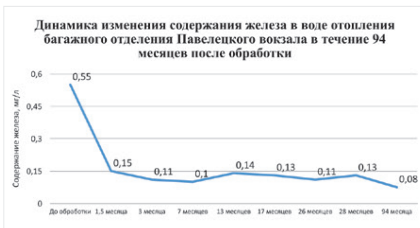
Рис. 14. Динамика изменения содержания железа в воде системы отопления багажного отделения Павелецкого вокзала в течение 94 месяцев после обработки
