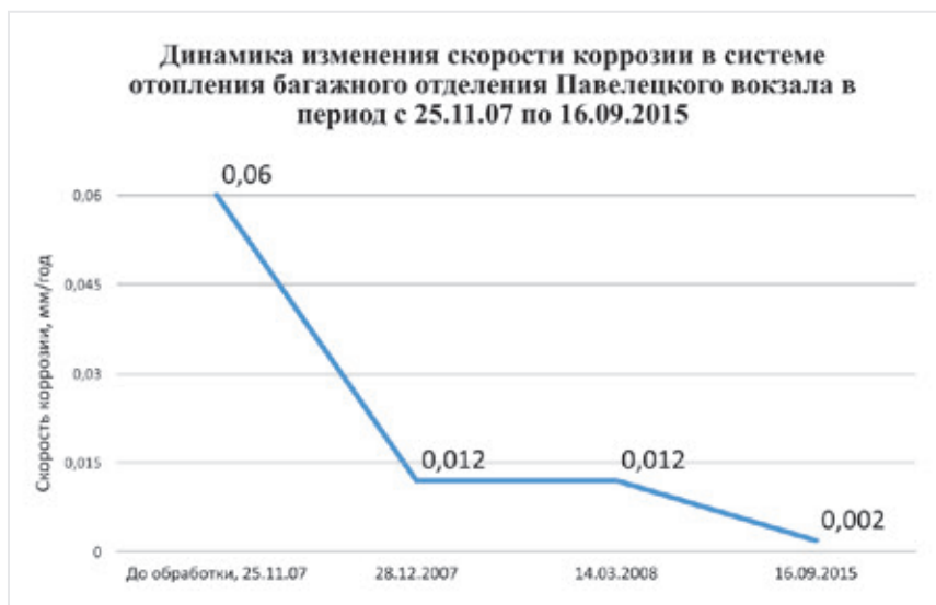
Рис. 12. Динамика изменения скорости коррозии в системе отопления багажного отделения Павелецкого вокзала в период с 25.11.2007 по 16.09.2015
