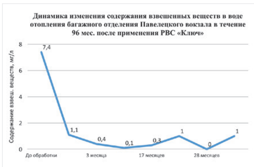
Рис. 13. Динамика изменения содержания взвешенных веществ в воде системы отопления багажного отделения Павелецкого вокзала в течение 94 месяцев после обработки
