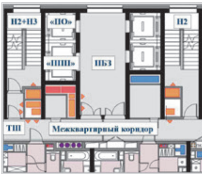
Рис. 1. Типовой лестнично-лифтовой узел жилого этажа
