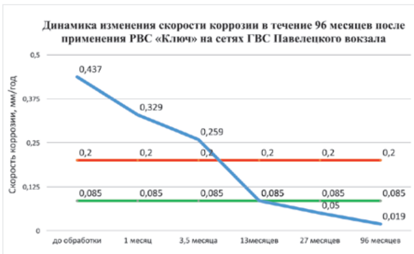
Рис. 8. Динамика изменения скорости коррозии в течение 27 месяцев после применения ЭМВ на сетях ГВС Павелецкого вокзала
