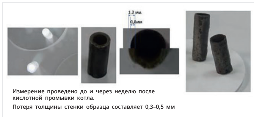
Рис. 10. Сравнительный вид образцов для замера скорости коррозии при ее величинах 0,084 и 1,46 м/год
