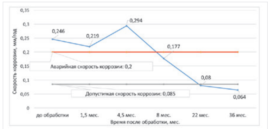
Рис. 2. Динамика изменения скорости коррозии в системе теплоснабжения депо
