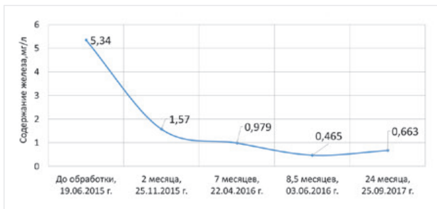
Рис. 8. Динамика содержания железа в обратной сетевой воде на протяжении 24 месяцев после ЭМВ
