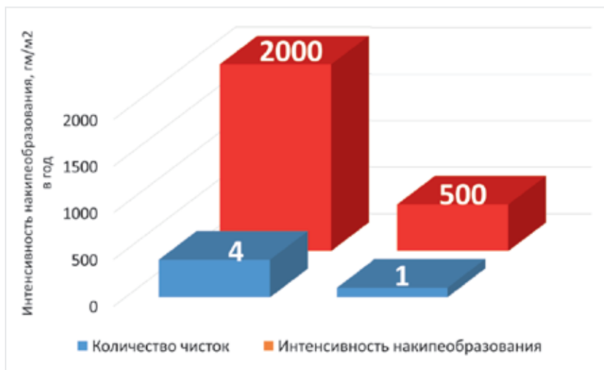
Рис. 6. Динамика интенсивности накипеобразования и количества необходимых чисток котлов до и после обработки
