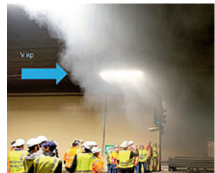
Рис. 5. Испытание с использованием искусственного горячего дыма продольной струйной вентиляцией тоннеля в Австрии, работающей в режиме контроля распространения дыма и тепла
