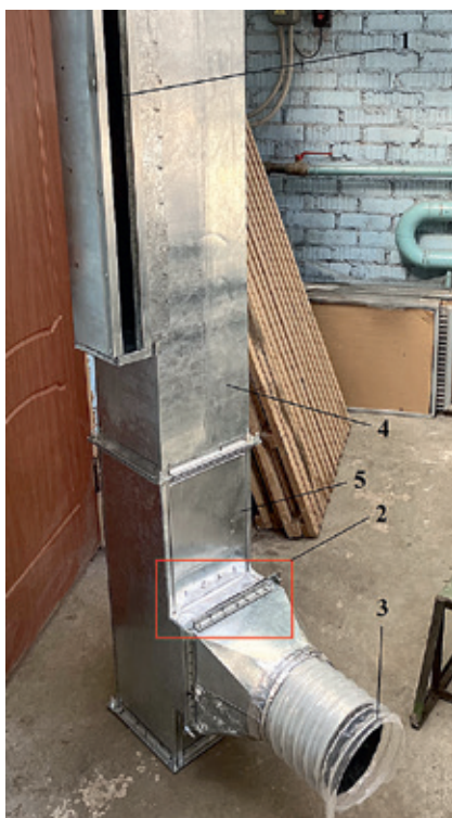
Рис. 1. Внешний вид разработанной колонны в сборе со всеми элементами: 1 — щель для подачи/удаления воздуха; 2 — точки измерения давления (полного и динамического) и скорости воздуха; 3 — подключаемый патрубок-воздуховод; 4 — верхний модуль колонны; 5 — нижний модуль колонны
