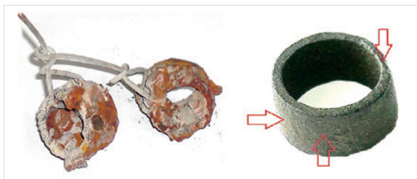
Рис. 18. Вид образцов для замера скорости коррозии до обработки ( V_{кор} = 0,655 мм/год) и после ЭМВ ( V_{кор} = 0,227 мм/год)
