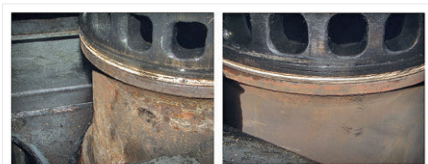
Рис. 20. Состояние втулок цилиндров до и через год после ЭМВ
