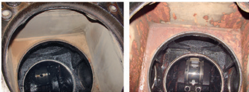
Рис. 22. Состояние рубашек охлаждения до и через год после обработки
