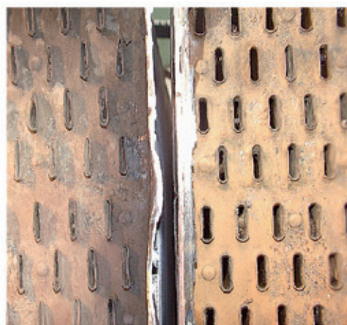
Рис. 23. Состояние секций холодильника до и через год после ЭМВ. Время пролива на стационарном стенде водяной секции без обработки составило 129 секунд, обработанной — 39 секунд
