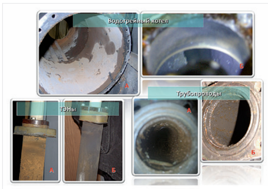
Рис. 10. Внешний вид трубопроводов, котлов, ТЭНов системы отопления пассажирского вагона до и через год после ЭМВ
