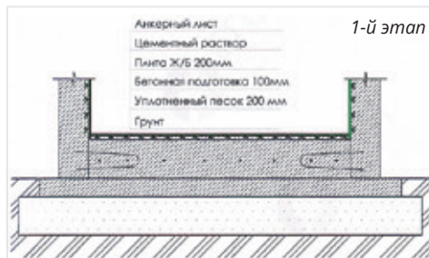
Рис. 5. Монтаж днища железобетонного резервуара
