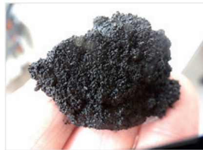
Рис. 6. Вид образовавшегося в результате микробиологической коррозии и ЭМВ скоагулировавшегося магнетита в металлопласте и низкозамерзающей жидкости
