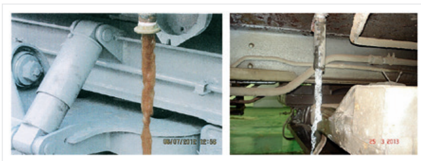
Рис. 17. Внешний вид сточных вод при использовании химической очистки трубопровода вагона и ЭМВ
