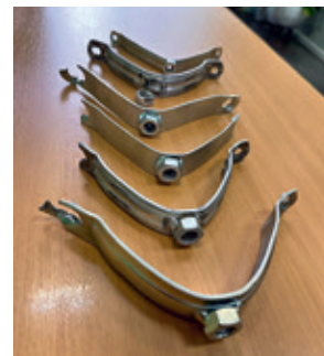
Трубные хомуты разных брендов после испытаний
