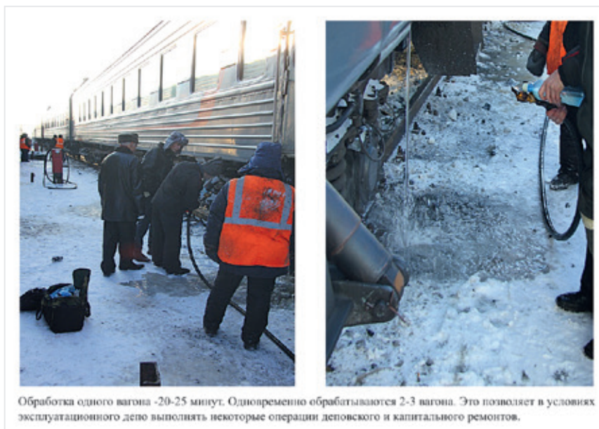
Рис. 9. Поточная обработка систем водотеплоснабжения пассажирских вагонов в условиях эксплуатационного депо
