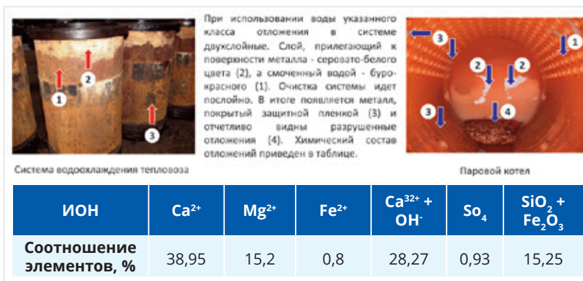
Рис. 1. Особенности очистки от отложений системы водоохлаждения дизеля тепловоза и парового котла при использовании воды кальций-гидрокарбонатного класса
