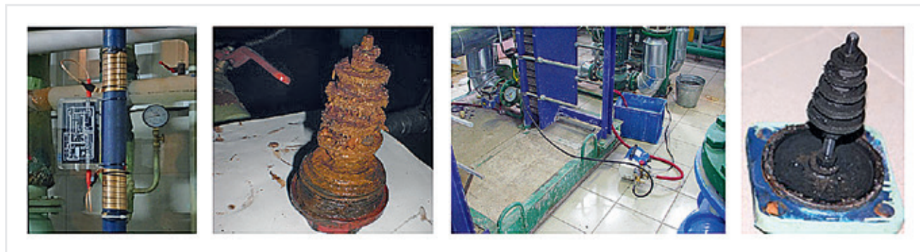
Рис. 18. Сравнительные испытания современного импортного устройства Vulkan-500 (Германия) и ЭМВ на тепловых сетях ОАО «РЖД» (2014–2015 гг.)
