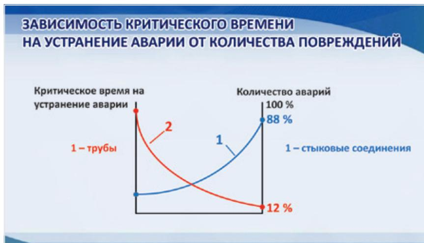
Рис. 7. Зависимость критического времени на устранение аварии от количества повреждений
