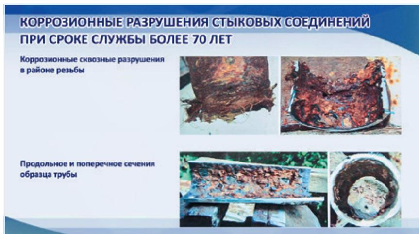
Рис. 6. Коррозионные разрушения стыковых соединений при сроке службы более 70 лет
