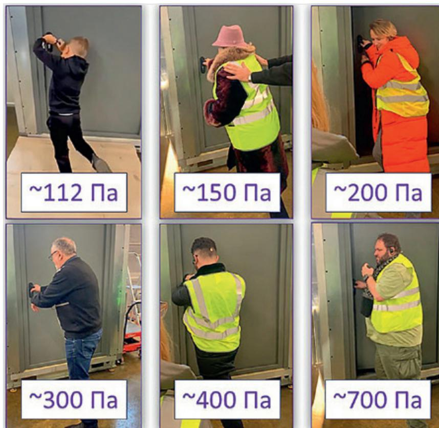
Рис. 2. Исследование физиологических способностей людей при открытии эвакуационной двери на различных перепадах давления
