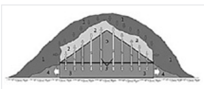
Рис. 4. Система охлаждения здания (Висячие сады Семирамиды): 1 — окружающий воздух; 2 — система озеленения здания; 3 — внутренние помещения в здании дворца; 4 — объем вокруг здания; 5 — каналы с охлажденным и увлажненным воздухом
