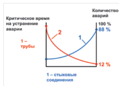
Рис. 3. Зависимость критического времени на устранение аварий от количества повреждений
