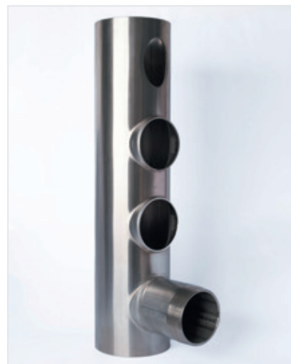
Рис. 2. Этапы изготовления коллектора с применением вытяжки отверстий
