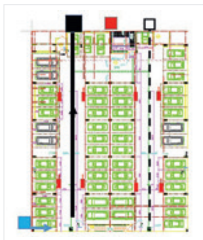
Рис. 3. Комбинированная схема вентиляции автостоянки площадью 4 000 m^2
