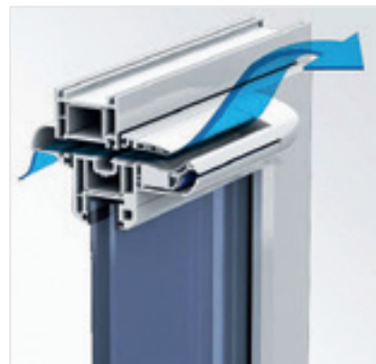
Рис. 1. Пример установки вентиляционного приточного клапана в профиль оконного стеклопакета
