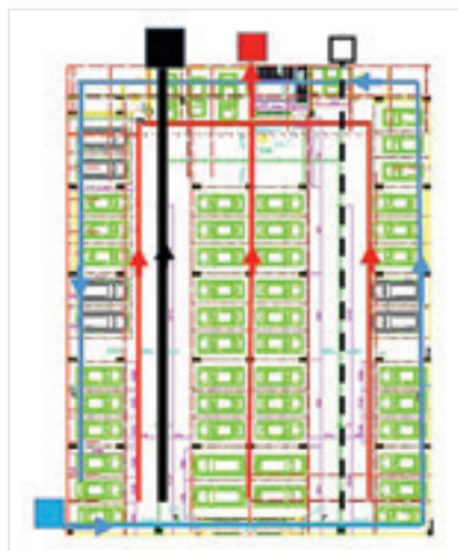
Рис. 1. Схема канальной общеобменной и противодымной вентиляции подземной автостоянки площадью 4 000 м 2
