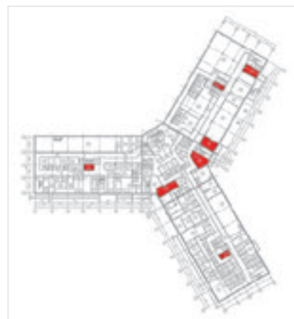
Рис. 6. Схематическое определение помещений для газового пожаротушения одного из этажей здания
