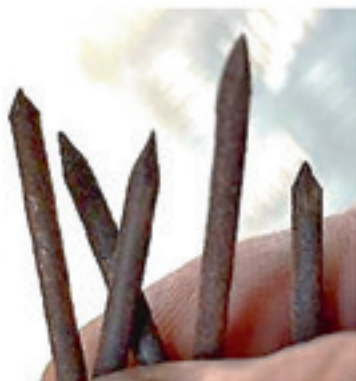
Рис. 10. Внешний вид образцов для замера скорости коррозии в децентрализованных системах после применения ЭМВ
