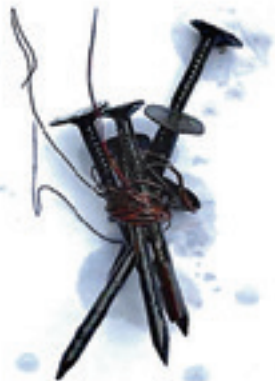
Рис. 10. Внешний вид образцов для замера скорости коррозии в децентрализованных системах после применения ЭМВ
