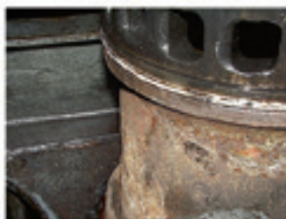
Состояние втулок цилиндров до и после однократной обработки и года эксплуатации
